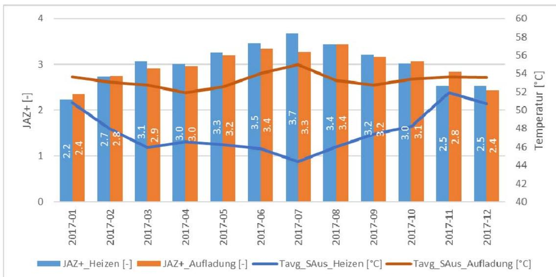
Abbildung 10: Darstellung der Jahresarbeitszahl JAZ+ und die mittlere Vorlauftemperatur «Tavg\_SAus» im Heiz- und Aufladebetrieb der Luft/Wasser-Wärmepumpe von Objekt 3.
