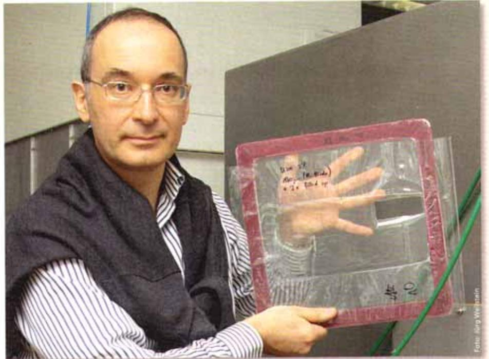
Farbstoff-Solarzellen: Frank Nüesch zeigt die Folie mit integrierten Gewebeelektroden.
