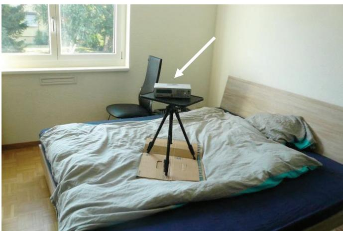
En plus des débits volumiques, les scientifiques de l'Institut de l'énergie dans la construction ont également mesuré différents paramètres de qualité de l'air comme les composés organiques volatils (COV), le CO<sub>2</sub> et la poussière fine. Sur l'image: montage expérimental pour la mesure des particules dans une chambre à coucher. Photo: IEBau, FHNW
