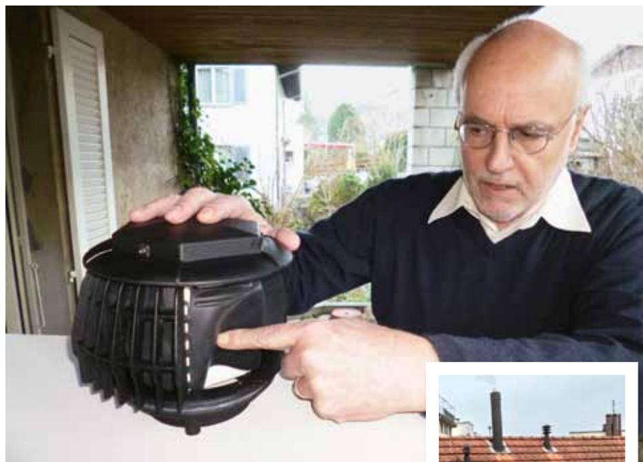
La soupape est installée sur le dispositif d'écoulement de l'eau de toit à la place d'une crapaudine. S'il ne pleut pas, la membrane reste fermée et empêche les pertes thermiques.
