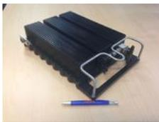
Der Wasserstoff für den Betrieb der Brennstoffzelle wird im Zug nicht in Druckflaschen mitgeführt, sondern in Speichermodulen, in denen nur ein geringer Druck von wenigen bar herrscht. Foto: CEKAtec
