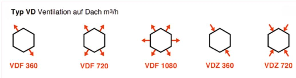
Je nach Anordnung der Membran-Ventile können unterschiedliche Funktio-nalitäten und Leistungen eingestellt werden.
