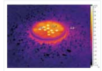
Thermobilder illustrieren die Energieverluste bei Funktionsöffnungen, z.B. dachintegrierten Entwässerungsabläufen.
