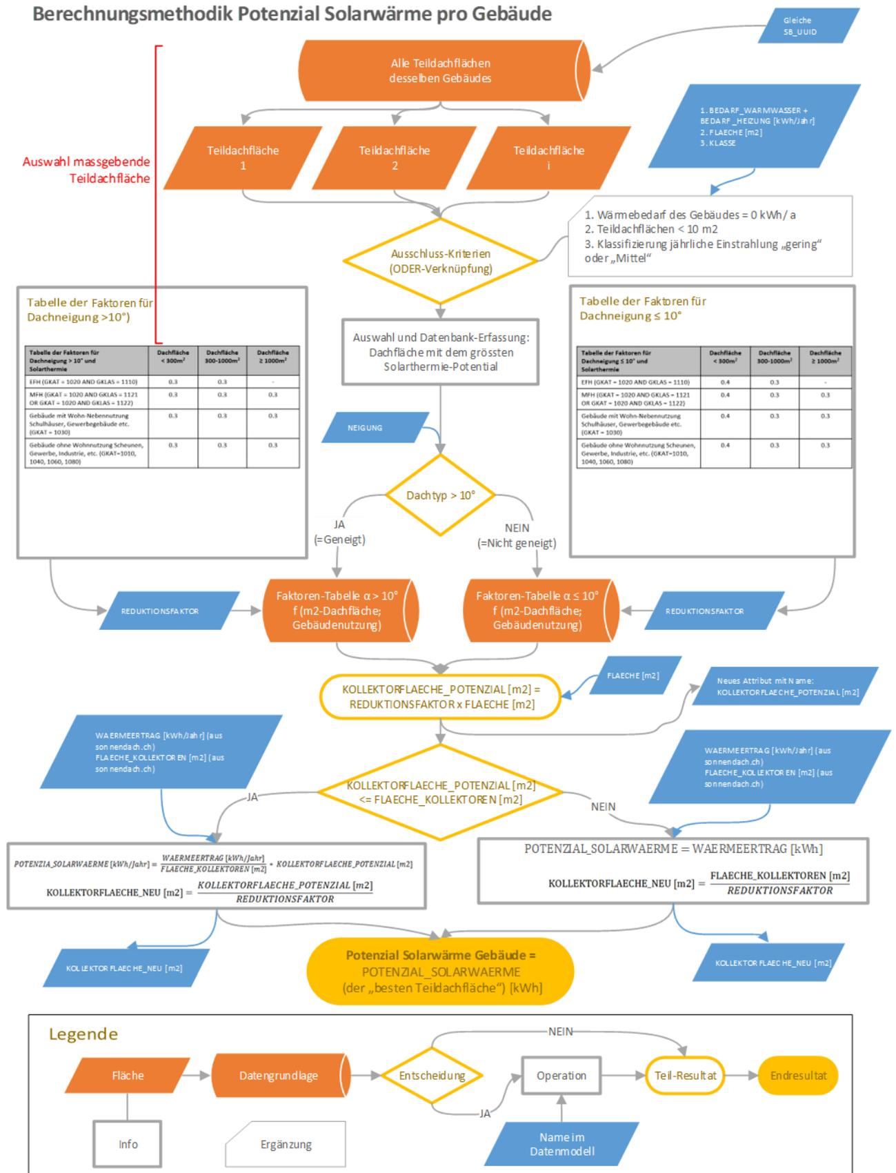
Abbildung 7 Berechnungsmethodik Solarwärme
