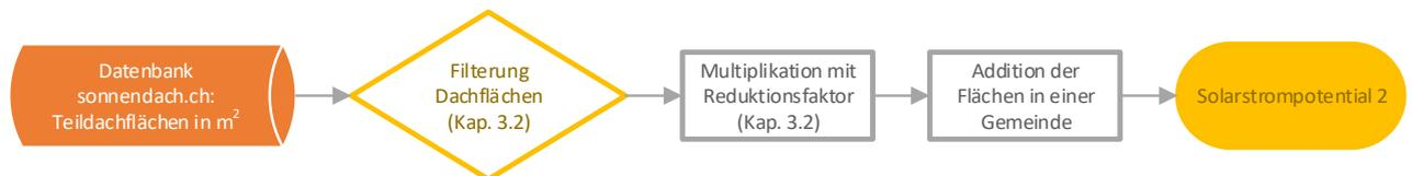
**Abbildung 2: Ablaufschema zur Berechnung von Potenzial „Solarstrom 2“**
