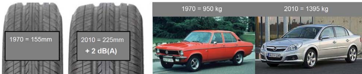
Fig. 4 : Evolution de la taille des pneus et du poids à vide d'une voiture de classe moyenne entre 1970 et 2010
