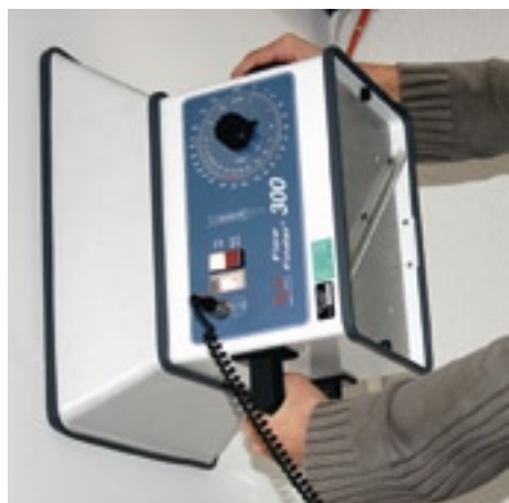
01 Messung des Luftvolumenstroms mit einem Flow-Finder-Gerät (Foto: Hochschule Luzern)
