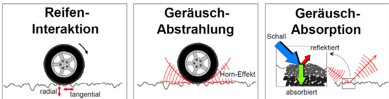
Abb. 5: Entstehungsmechanismen des Reifen-Fahrbahn-Geräusches
