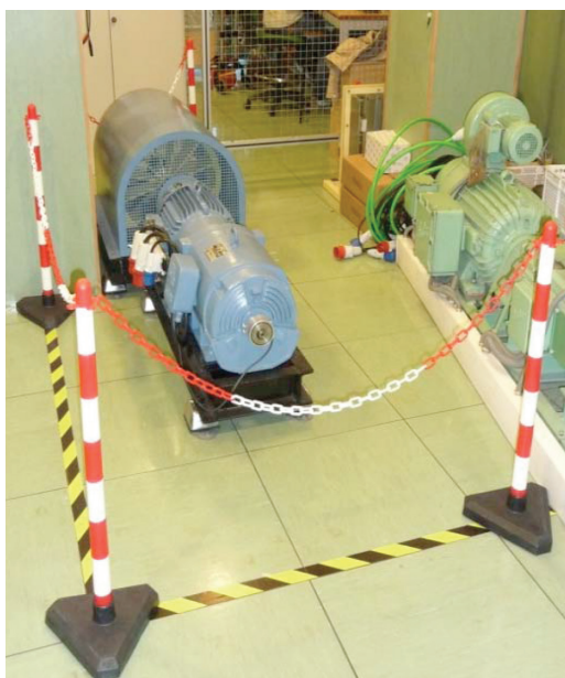
Blick auf den Maschinensatz des Prüfstandes, mit dem die Berechnungsmodelle zum Excitation Booster validiert wurden. Foto: Alstom
