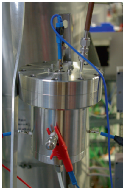
Kurze Verbindungsrohre zum Abgasstrom waren eine der wichtigsten Anforderungen für einen kompakten Aufbau des Reaktors.
