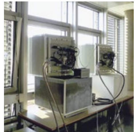
02 Die Messeinrichtung für den g-Wert. (Foto: Peter Gallinelli/Hepia)
