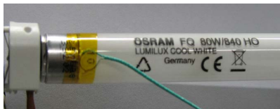
Figur 7 Messung der Cold Spot - Temperatur einer T5 Lampe
