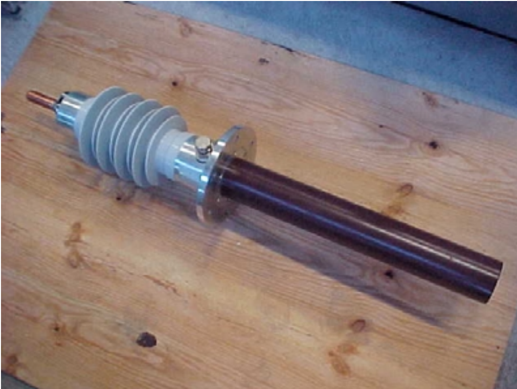
Fig 8: Borne 24 kV, BIL 125 kV. La partie entrante est prolongée afin de gérer l'interface Azote gazeux puis azote liquide.
