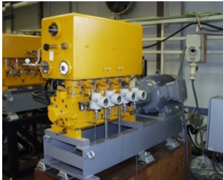
Fig 10 : vue de la machine à froid Stirling 4.4kW à 77K
