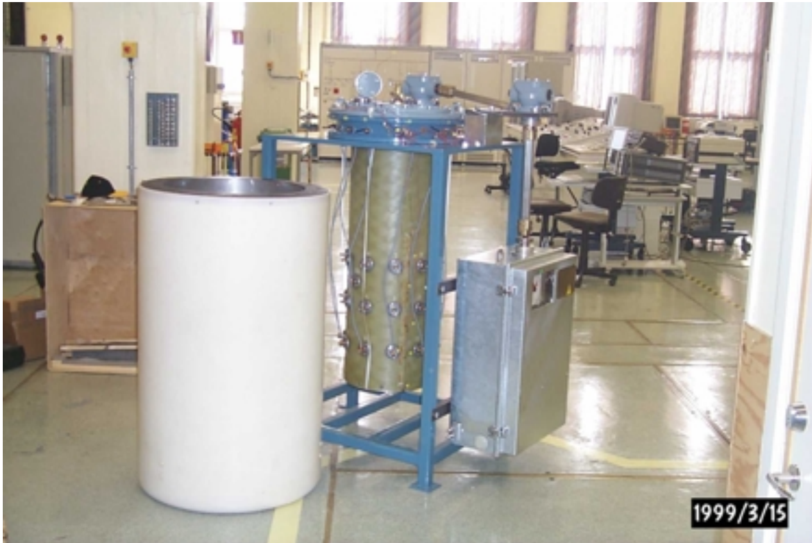
Fig 11: le changeur de prise et son cryostat d'essai après les essais
