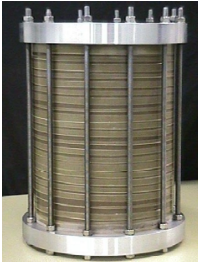
Fig 7: bloc enroulement subissant un test de compression
