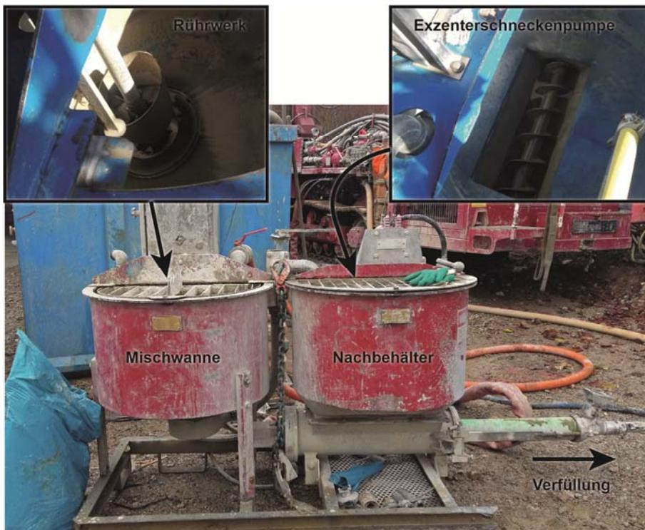
Fig. 2 Miscelatore colloidale
