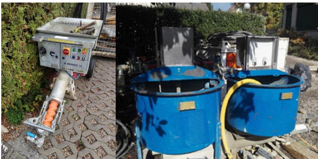
Figura 7 Pompa di miscelazione singola malta (a sinistra), Miscelatore colloidale (a destra)
