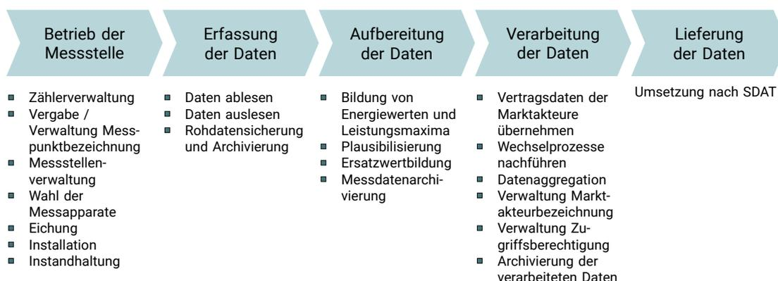
Abbildung 2.1.: Prozessschritte des Messdatenmanagements nach Metering Code
