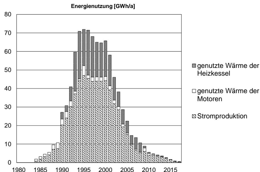
**Deponiegasnutzung mit Gasmotoren (WKK)**
