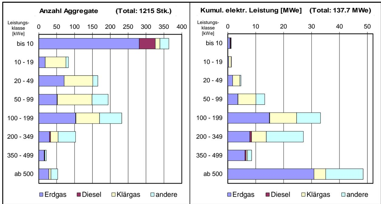
Bild 6.1f Ende 2017 in Betrieb stehende Klein-WKK-Aggregate, geordnet nach Leistungsklassen und nach Energieträgern
