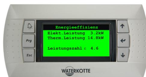
Abbildung 6: Leistungsanzeige von Waterkotte-Wärmepumpen [WAT14]
