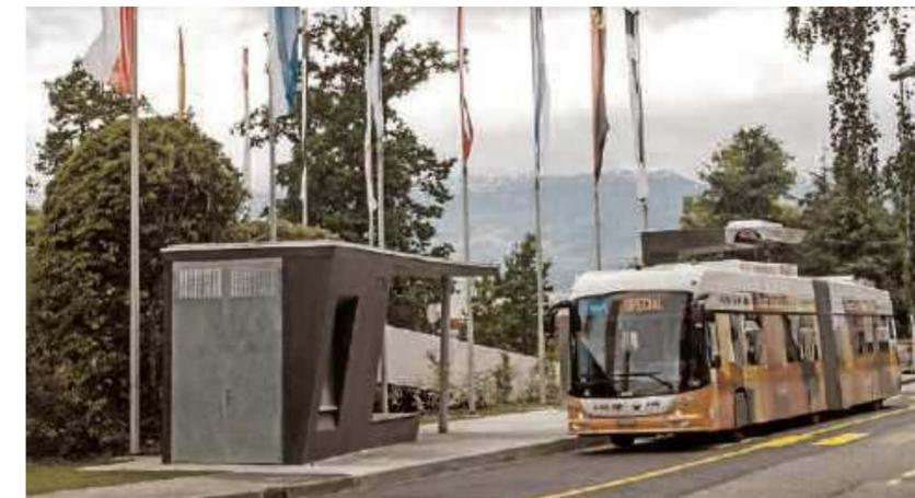
L'autobus elettrico operativo a Ginevra è dotato di una batteria di dimensioni relativamente piccole che viene ricaricata in pochi secondi alle fermate. Giunto sotto la pensilina, l'autobus si aggancia alla stazione di ricarica (visibile nella figura sopra il tetto dell'autobus). (ABB)
