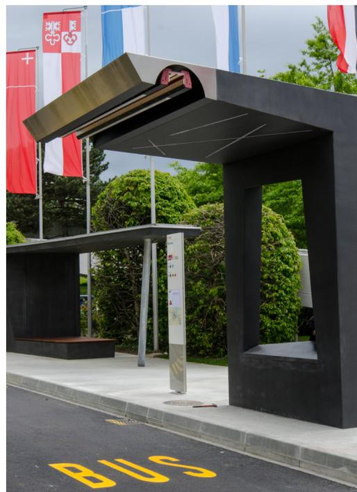
De telles stations de chargement sont nécessaires pour que le bus électrique puisse recharger sa batterie aux arrêts sélectionnés. Photo: ABB
