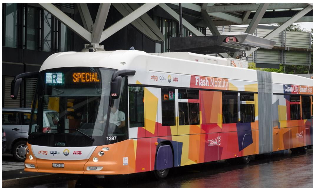
Le bus dispose d'une batterie qui se recharge pendant les arrêts. Pour cela, il se raccorde à une station de chargement (visible sur le toit du bus). Photo: ABB
