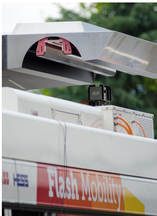
Le bus s'arrête, un balai conducteur se déplace automatiquement vers son toit, passe sur un rail de chargement au-dessus de l'arrêt de bus et y pompe du courant. Photo: ABB
