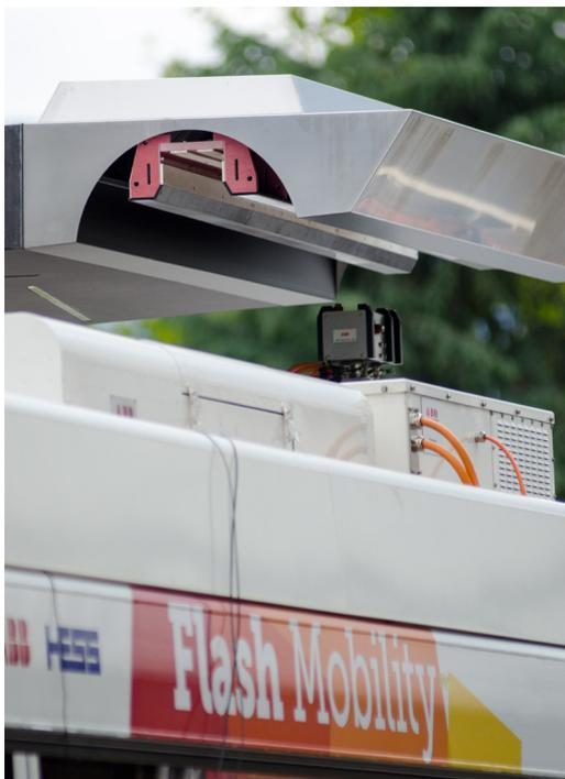
Beim Ladevorgang fährt ein Stromabnehmer vom Dach des Busses vollautomatisch hoch und bezieht von der Ladeschiene über der Haltestelle elektrische Energie. Foto: ABB
