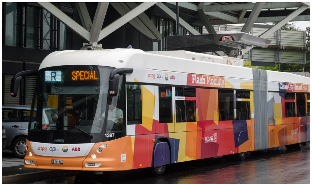
Der Genfer Elektrobus wird während den Stopps an den Haltestellen nachgeladen. Dazu dockt der Bus an eine Ladestation (im Bild sichtbar über dem Dach des Busses) an. Foto: ABB
