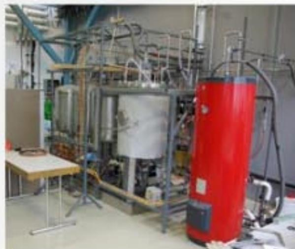
Wärmespeicherung mit thermochemischem Prinzip und der Nutzung von Natronlauge. (Bild: Empa Dübendorf)
