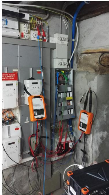
Mesure de terrain sur le réseau basse tension d'Avusy, une commune rurale dans le sud-ouest du canton de Genève. L'alimentation énergétique de deux installations photovoltaïques est mesurée à l'aide de smart meters. Le troisième compteur intelligent mesure la consommation électrique dans la maison. Photo: D. Roggo
