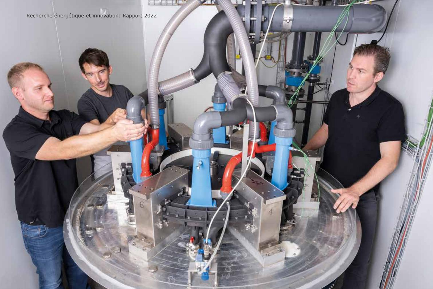
Swiss Blue Energy étudie depuis 2012 le développement d'un moteur thermomagnétique. L'entreprise de Bad Zurzach (AG) se concentre sur le développement de méthodes de production d'électricité sans émissions qui utilisent la chaleur résiduelle à une température comprise entre 20 et 80 °C (source: Swiss Blue Energy).
