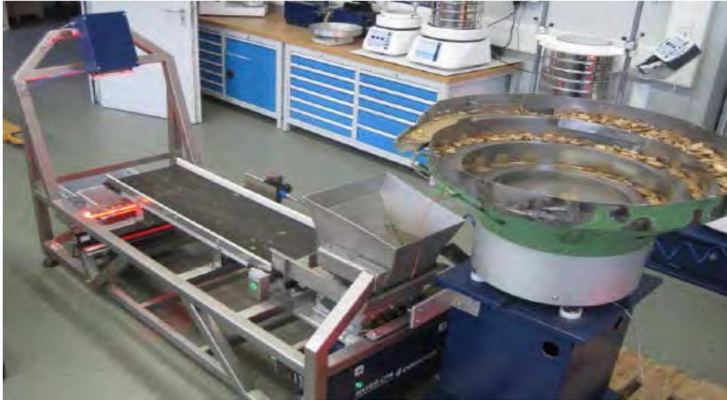
**Bild 1:** Bildanalyse HAVER CPA 4 CONVEYOR, Bandgerät zur Größen- und Formanalyse im Messbereich von 96µm bis 220mm
