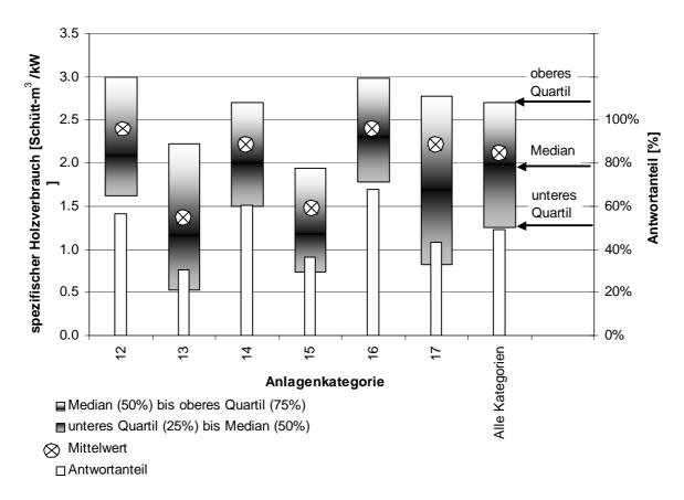
Abbildung III.6 Spezifischer Holzverbrauch in Schüttkubikmeter pro kW Feuerungsleistung
