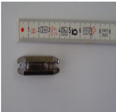
Fig. 1 Überspannungsableiter
