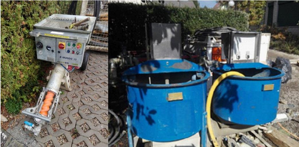
Abbildung 7 Mörtelmischpumpe (links) und Kollodialmischer (rechts)
