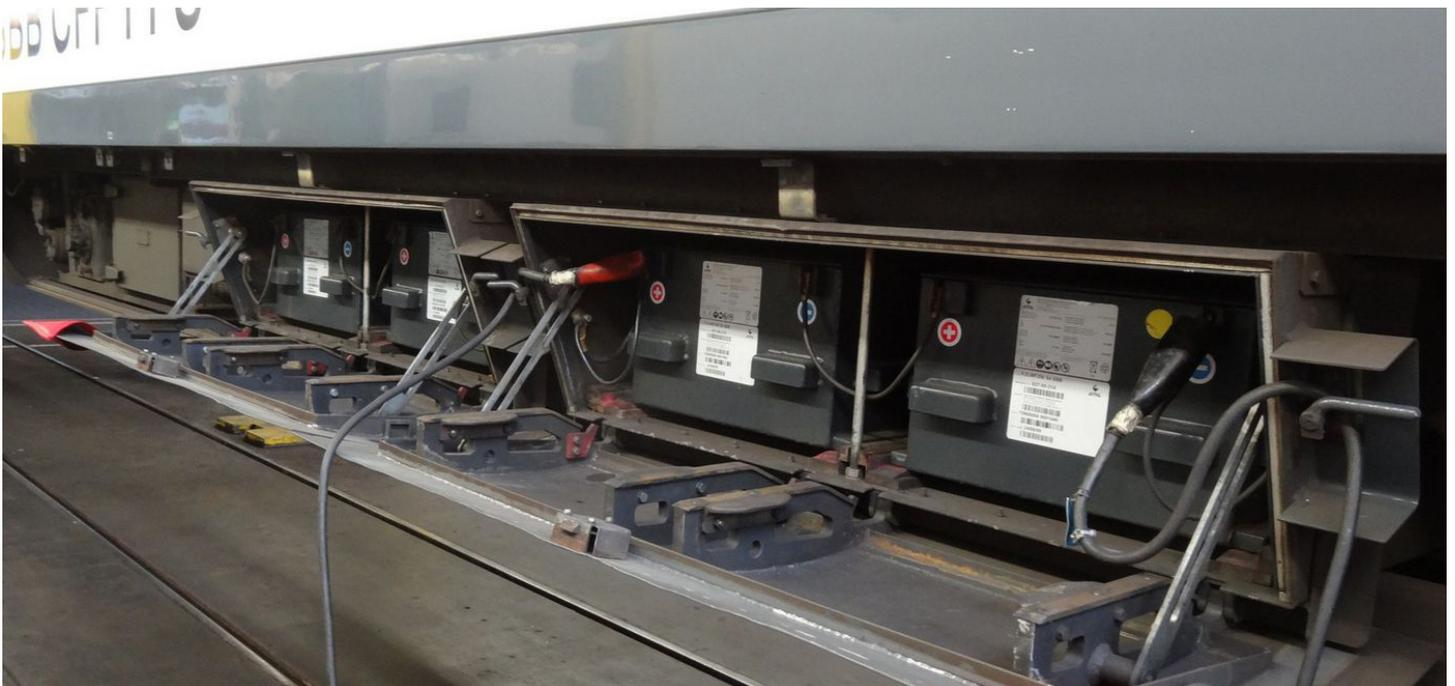
Le train de voyageurs EW4 dispose de deux faisceaux de batterie 36 V parallèles, actuellement installés dans quatre récipients comprenant chacun une batterie au plomb 18 V. Photo: CFF
