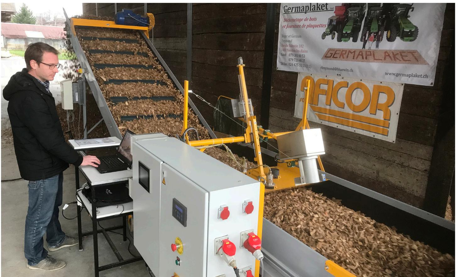
Thierry Stäger, Forscher an der HEIG-VD, bedient die neuartige Messanlage. Die silbriggraue Box über dem Förderband ist das Infrarot-Gerät zur Messung der Feuchtigkeit. Um die Feuchtigkeit mit Mikrowellen zu bestimmen, dient die gelbe Platte, die direkt auf den Hackschnitzeln aufliegt (auf dem Foto durch das IR-Gerät verdeckt). Foto: B. Vogel
