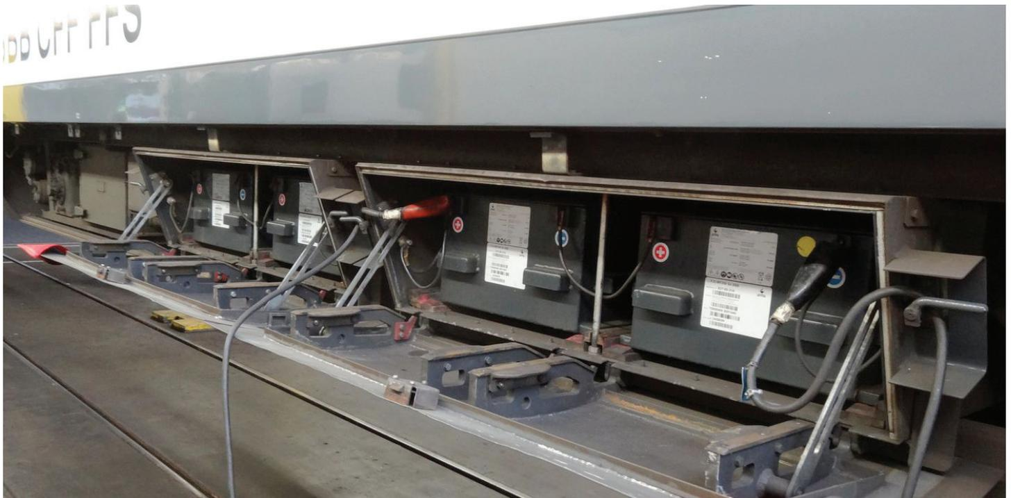
Der Reisezugwagen EW4 führt zwei parallele 36 V-Batteriestränge mit, aktuell in vier Trögen mit je einer 18 V-Bleibatterie untergebracht. Foto: SBB
