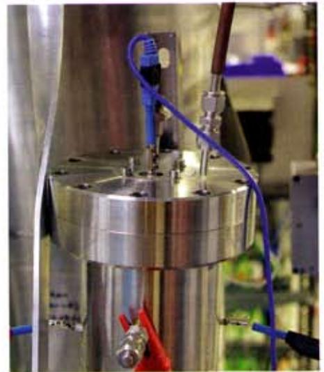
Kurze Verbindungsrohre zum Abgasstrom war eine der wichtigsten Anforderungen für einen kompakten Aufbau des Reaktors.
